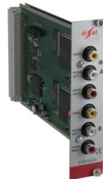
**DSAV2:** Этот двухканальный кодер аудио/видео обеспечивает кодирование двух входов CVBS в формат MPEG-2 и их объединение в один транспортный поток.
