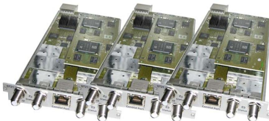
Рисунок 3. Модули-преобразователи для станции Tangram.
